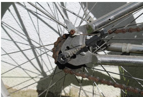
Zustand fraglich: eine alte Torpedo-Nabenschaltung mit Schaltkettchen
