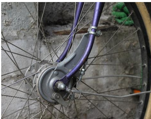
Lieber nicht: eine alte Trommelbremse
