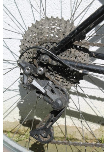
Kettenschaltungen sind leicht austausch- und reparierbar
