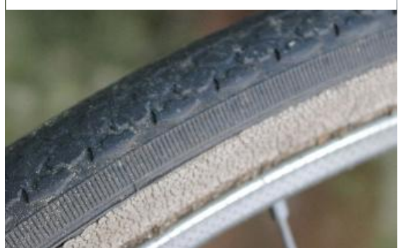
Porös und abgefahren: Dieser Reifen sollte sofort gewechselt werden
