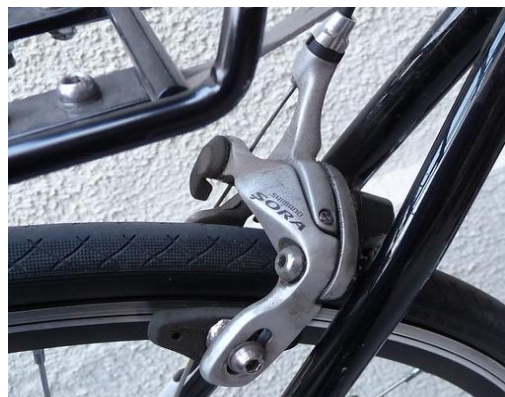
Eine moderne Rennrad-bremse mit zwei Gelenken
